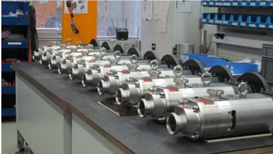
Endmontage von HYGHSPIN 50-Pumpen für einen US-Kunden
